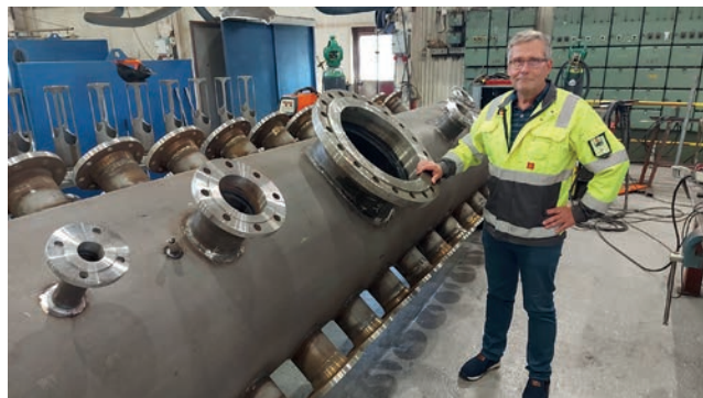
Uuden tyyppinen sähkökattila valmistuu Viitos-Metallin konepajassa. Tässä vastusyhteet on kiinnitetty kattilan runkoon. Esittelijänä myyntipäällikkö Kaj Sundberg.
