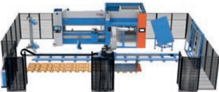
Prima Powerin taivutusrobottisolu, joka integroi 7-akselisen antropomorfisen robotin automaattisella työkalunvaihtajalla varustettuun, sähköservokäyttöiseen eP Genius 1030 -särmäyspuristimeen.
