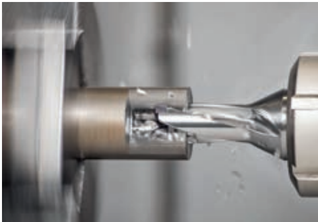
Kärjet kiinnitetään ISCARin kolmileikkuisen D3N...-poran runkoon helposti kiertämällä.
