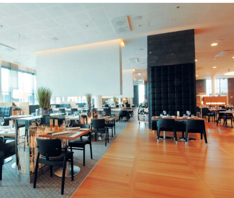
Ravintolan lattiassa on käytetty Bambu massiivisauva parkettia. Toimitus ja asennus: Parketti Romanoff Oy.
