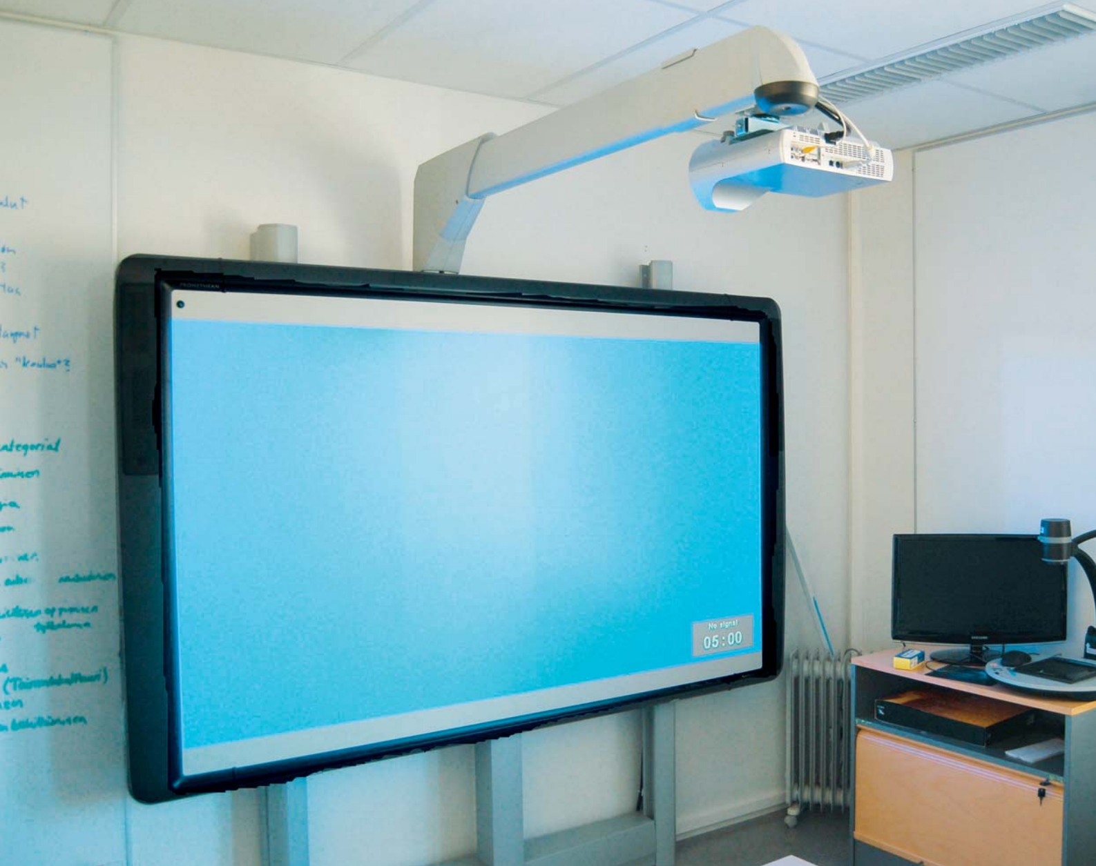
Kosketusnäytöllisessä Promethean-valkotaulussa dataprojektori on asennettu tauluun kiinnitetyn varren päähän.
