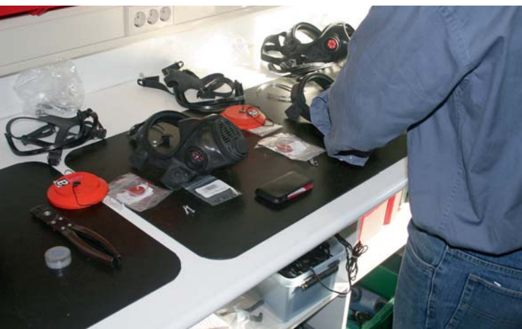
Keskityttyä huollossa suojaimet puretaan, puhdistetaan ja kulutusosat vaihdetaan, lopuksi tehdään tiiveystesti. Puhallinmoottorin ”loki” tallennetaan dokumentiksi.
