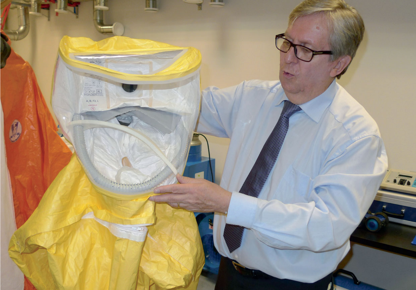
T-Air puhallinmoottori voidaan kytkeä kemikaalisuojapukuun, sille varattuun paikkaan vyötäröllä. Virtaava ilma estää myös visiiriosan huurtumisen.
