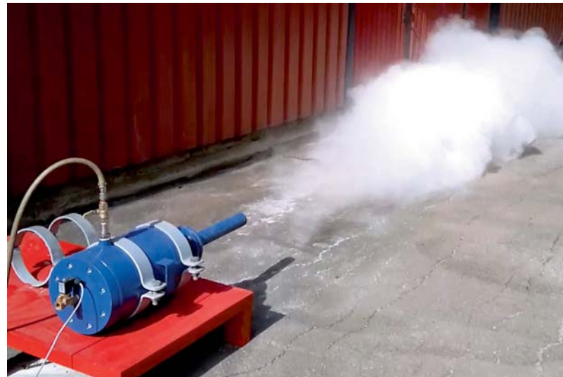
Siilotykki tuottaa voimakkaita paineimpulsseja.
