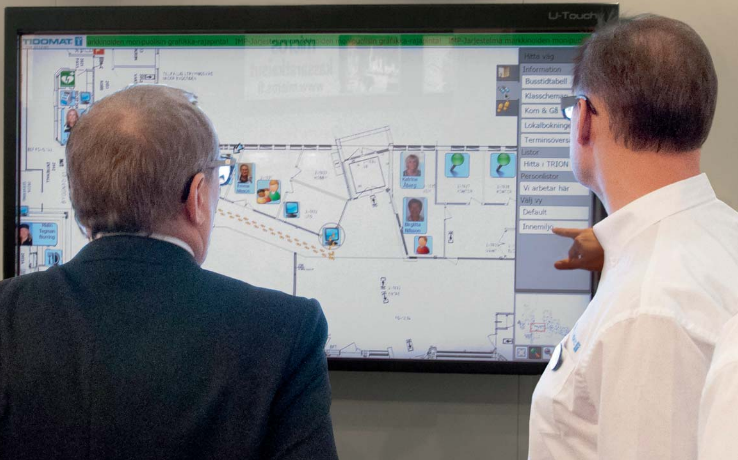
Tidomat IMP on erilaisten integroitavien turvallisuus- ja kiinteistöjärjestelmäratkaisujen yhteishallintaan kehitetty graafinen käyttöliittymä, joka tarjoaa käyttäjystävällisen ja selkeän rajapinnan esim. kulunvalvontajärjestelmän reaaliaikaiseen tarkkailuun ja hallintaan.
