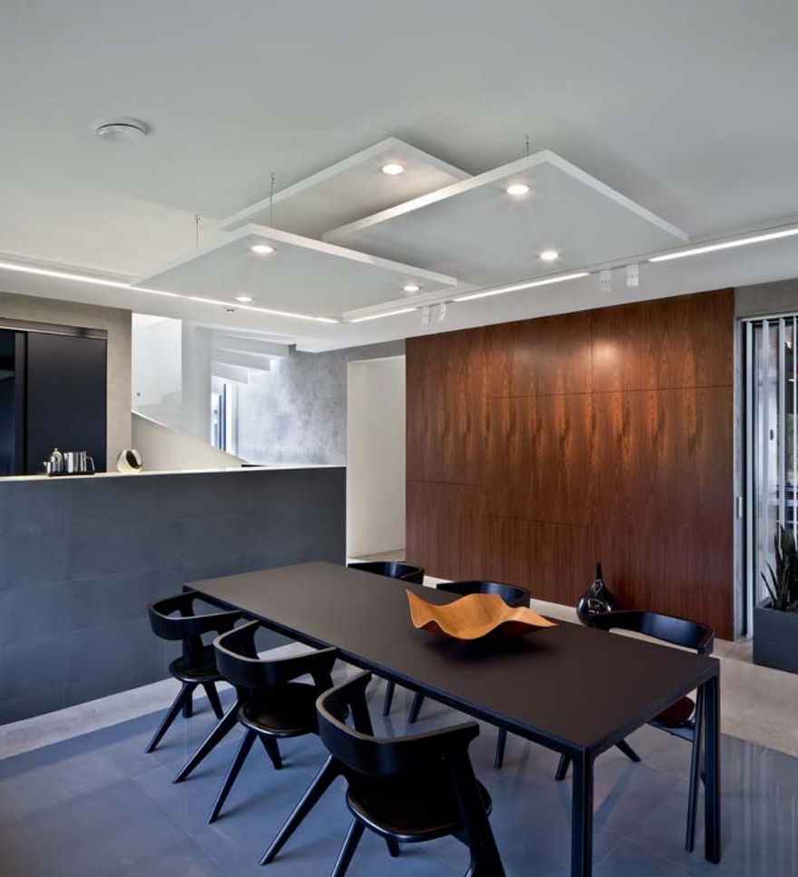
Ruokailutilan yläpuolella eri tasoihin asennettu Ecophon Solo 1 200 x 1 200 mm leijuvat akustiikkalevyt, joihin upotettu valospotit.
