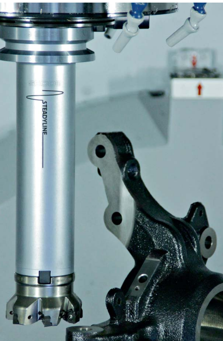
Pitkien ulottumien haasteet voidaan ratkaista värinävaimennetuin pitimin.
