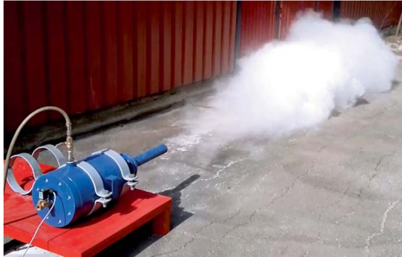
Siilotykki tuottaa voimakkaita paineimpulsseja.
