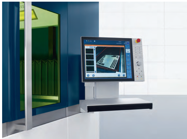
Drop&Cut toiminto helpottaa tuotantoa olemaan kustannustehokkaampi mahdollistaen jäännöslevyjen tehokkaan käytön.
