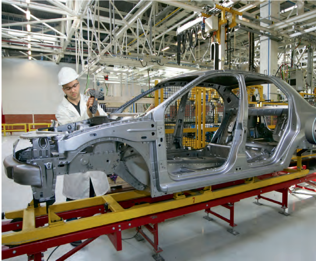
Auton korin mittaus Creaform Handy Probe koordinaattimittalaitteella.
