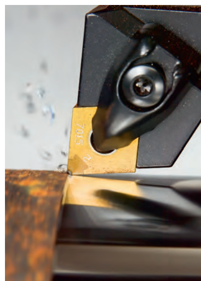
Sandvik Coromantin terälaatu CB7015 on ensisijainen valinta hiiletyskarkaistujen vaihteisto-osien sorvaukseen.
