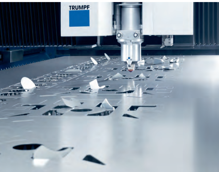
Uusi Smart Collision Prevention törmäyksen esto minimoi riskit laserpään kolarisiin optimoidun leikkausstrategian avulla.
