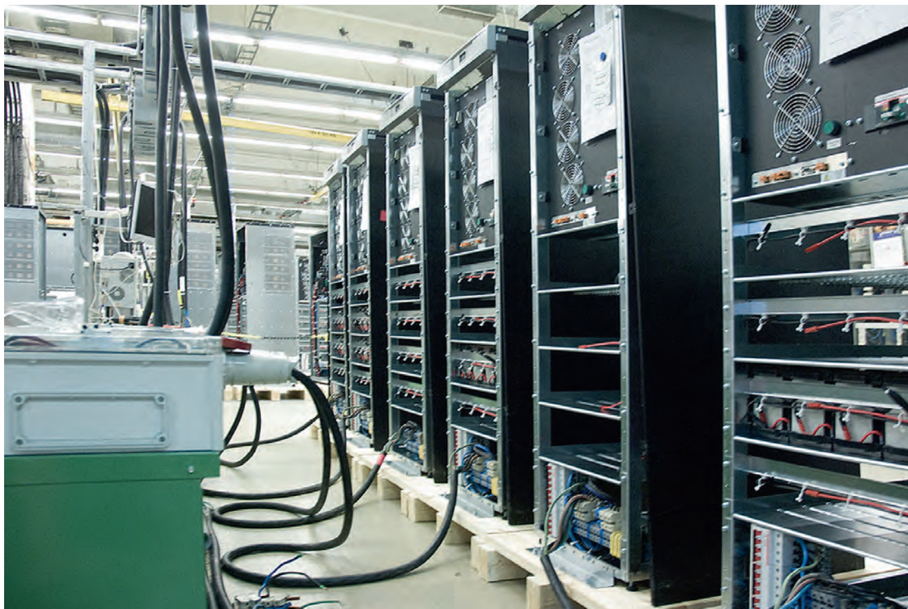
UPS-laitteita testataan Eatonin tehtaalla.
