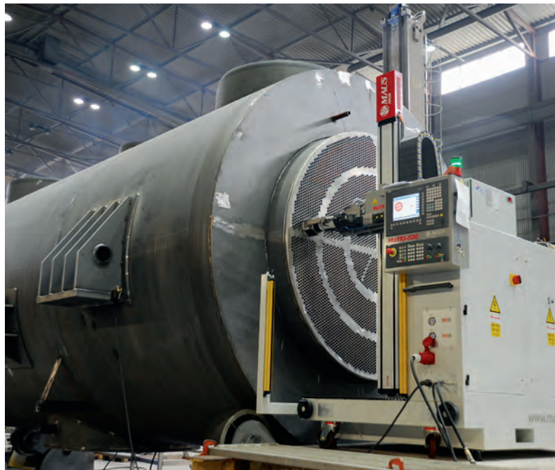
Lämpöpintaputkien tiivistehitsaus automaattilla.
