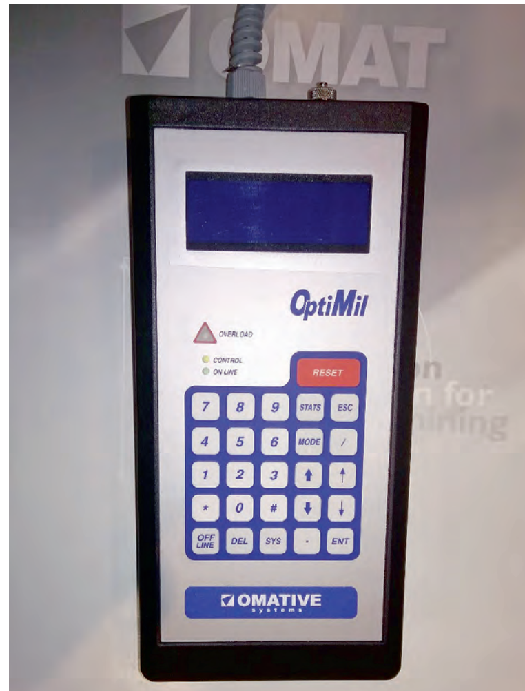
Kuvassa adaptiivinen ohjainlaite jyrintään, sorvaukseen ja hiontaan. Voidaan liittää vanhoihin ja uusiin työstökoneisiin.
