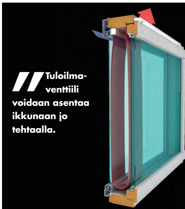
Kun ikkunan suodatinpalkki on talviasennossa, korvausilma lämpiää tuloilmaikkunan välitilassa. KUVA: DIR-AIR OY
