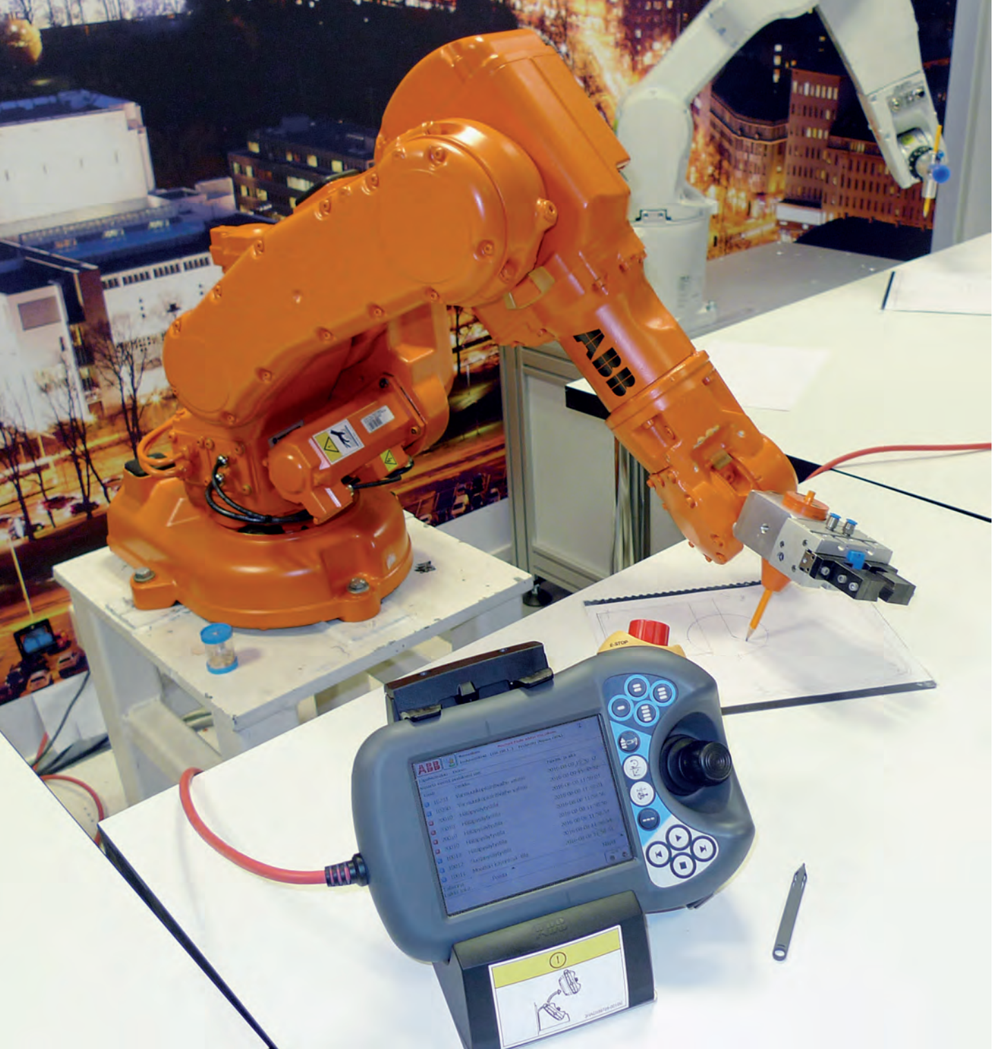
ABB:n koulutusrobotit Vantaalla käyttävät kyniä ja työkaluja ohjelmoinnin mukaisesti.
