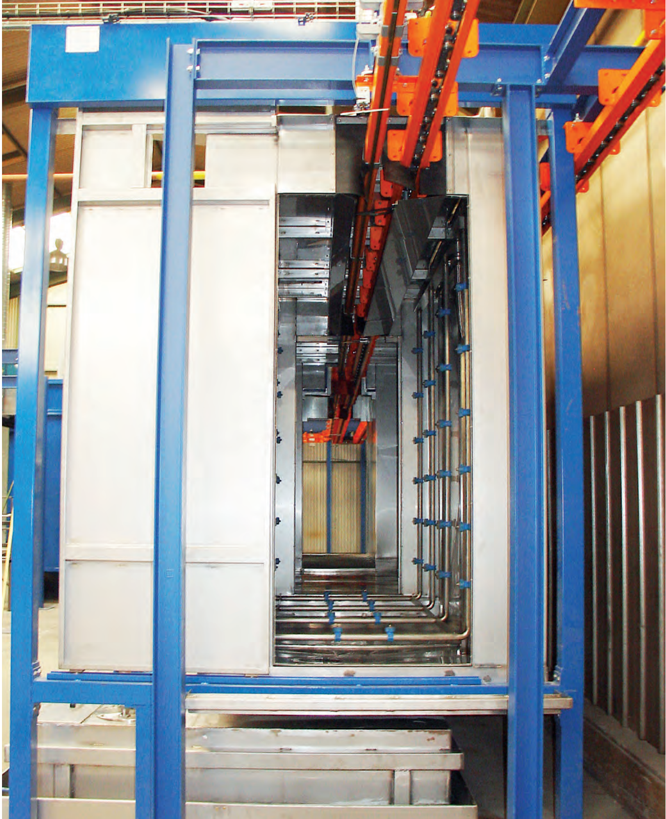
Automaattinen suihkypesulaite vaatii vähän tilaa.
