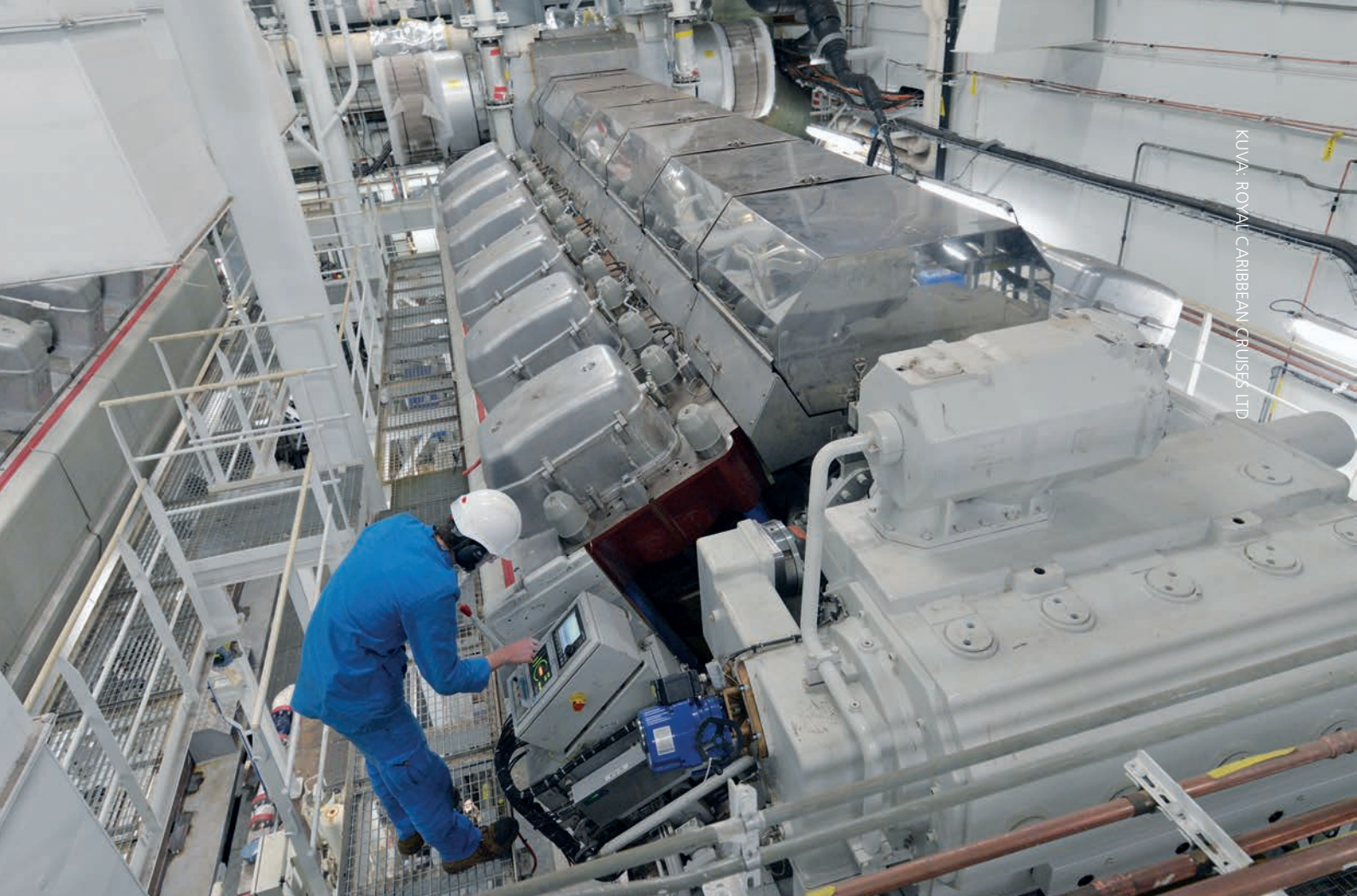
Moottorien testausta ensi kertaa avovesillä. Wärtsilä toimitti moottorit: neljä 12-sylinteristä Wärtsilä 46F-moottoria ja kaksi 16-sylinteristä Wärtsilä 46F-moottoria.
