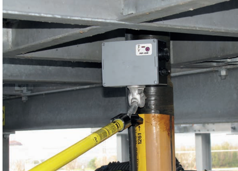
Mittalaitteperheeseen kuuluva siirrettävä kamera rekisteröi sähköisiä purkauksia ja koronailmiöitä. Se kerää kattavat tiedot koko pulssiaallon muodosta ja luonteesta nanosekuntien tarkkuudella.
