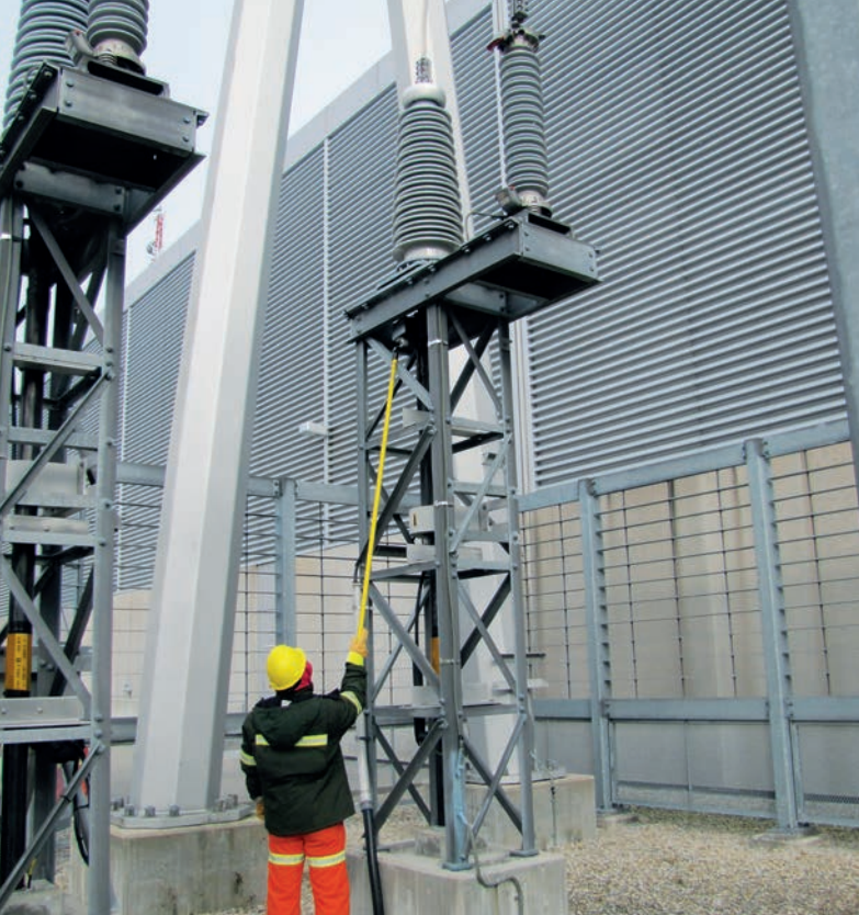
Mittalaitteperheeseen kuuluva siirrettävä kamera rekisteröi sähköisiä purkauksia ja koronailmiöitä. Se kerää kattavat tiedot koko pulssiaallon muodosta ja luonteesta nanosekuntien tarkkuudella.
