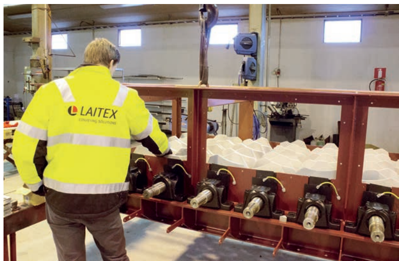
Turku Energian tilaama polttoaineen ulkokäsittelyjärjestelmän toimitus on suurimpia projekteja Laitexin historiassa euroissa mitattuna. Myös hankkeen työllistävä vaikutus on merkittävä. Kuvassa Laitexin työntekijä ja kiekoseula.
