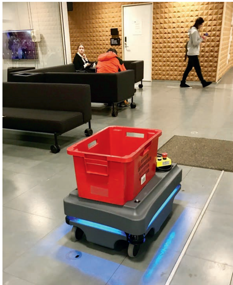
Kuvassa Oodin robotti, joka kuljettaa kirjoja varastoon – valot vilkkuvat ja se osaa väistellä esteitä sekä käytävillä kulkevia ihmisiä.
