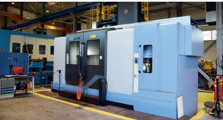
CNC-Koneistus Oy:n uusin karusellisorvi Doosan Puma VTR1620M, jonka suurin sorvaushalkaisija on 2,1 metriä.
