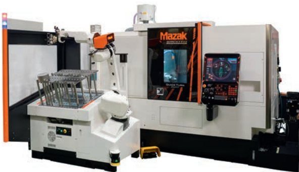
Mazak Quick Turn 250MSY -sorvauskeskus ja siihen saumattomasti integroitu TA-20/200 -robottijärjestelmä tarjoavat helpon ensiaskelen automaation hyödyntämiseen.
