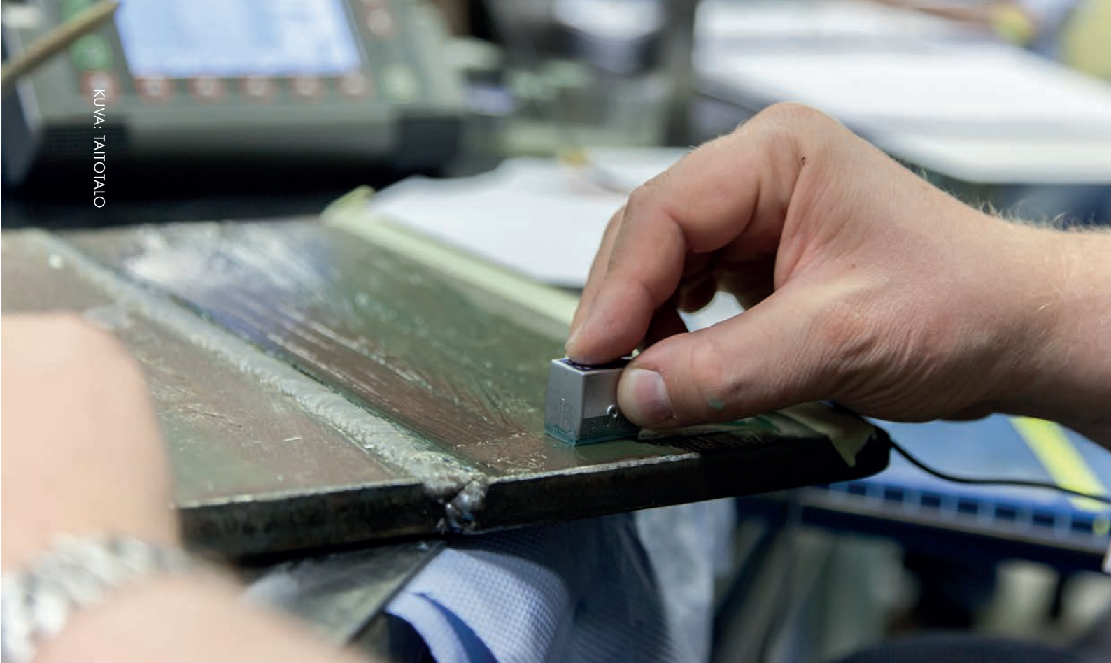
Taitotalo tarjoaa NDT-koulutusta useaan eri tarkastusmenetelmään. Ultraäänitarkastusta harjoitellessa löytyvät hitsin mahdolliset sisäiset virheet.
