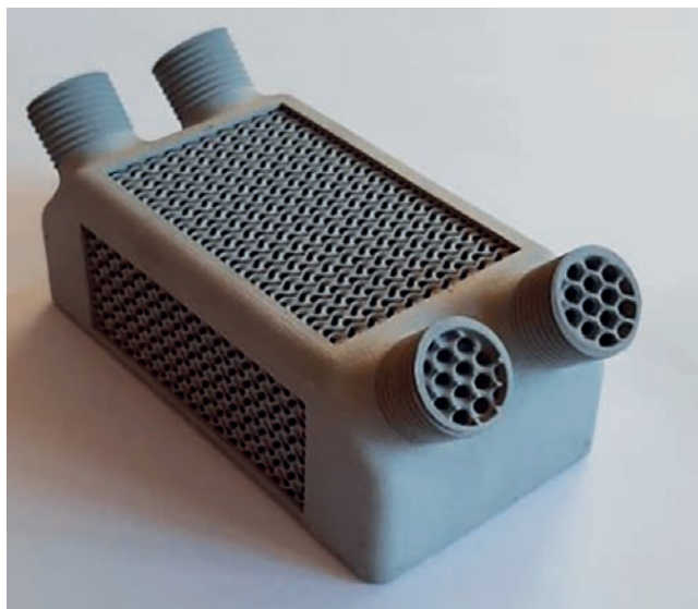
VTT tutkii muun muassa sideainesuihkutusteknologian soveltuvuutta erityyppisille kappaleille ja geometrioille.
