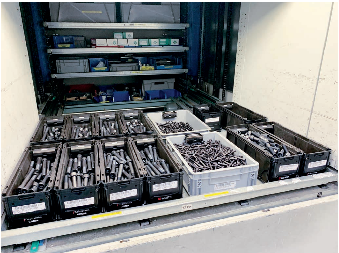
CleverBin-laatikossa optinen silmä tarkkailee pinnan tasoa ja tekee täydennystilauksen, kun ennalta asetettu tilauspiste alittuu.
