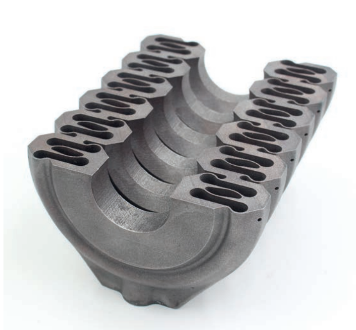
Puolikas pultinkiristin työkaluteräksestä (MS1). Kanaviston testattu paineenkesto yli 500 baaria (Merinova-hanke).
