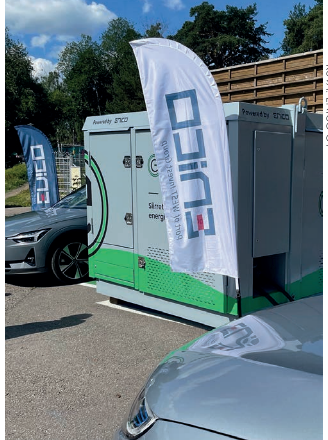
Enicon siirrettävä energiavarasto MobileESS on mahdollistanut tänä kesänä sähköautojen latauksen Särkänniemessä.
