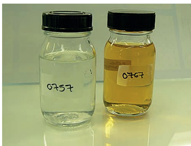
Ero puhtaan ja likaisen glykolinäytteen välillä on silmin havaittavissa.
